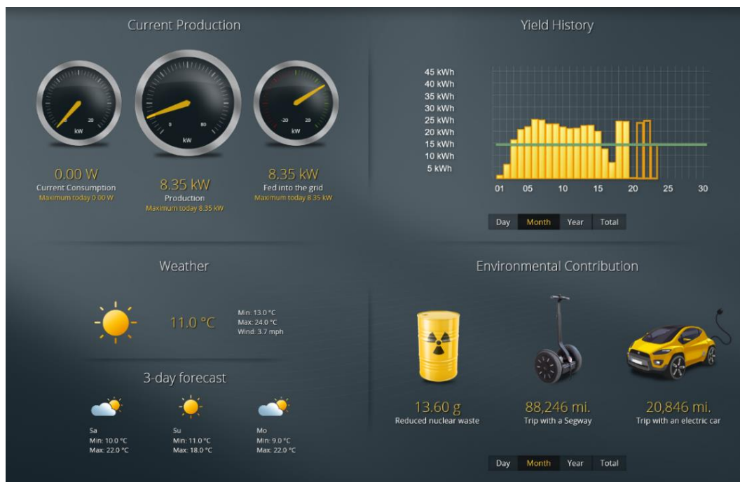
Figur 3. Solar log dashboard. Exempel på hur data från solcellssystemet kan presenteras i webbportal kopplad till en extern webblogger från Solar log.
